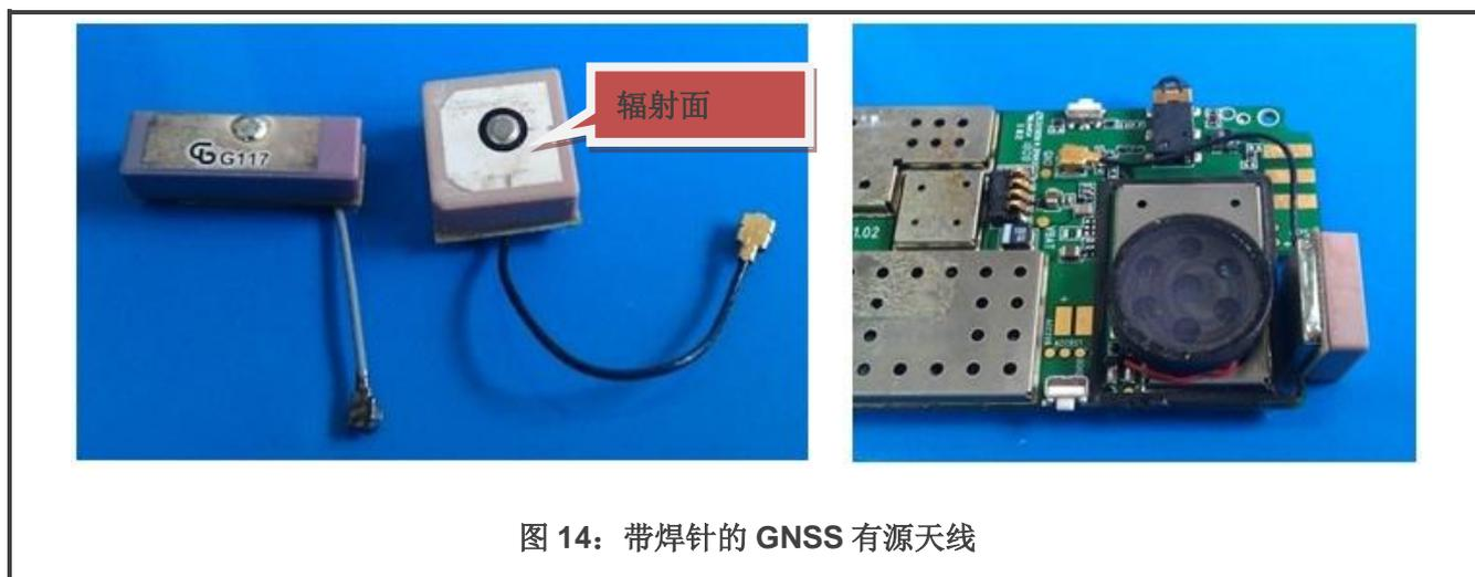
图 14: 带焊针的 GNSS 有源天线
